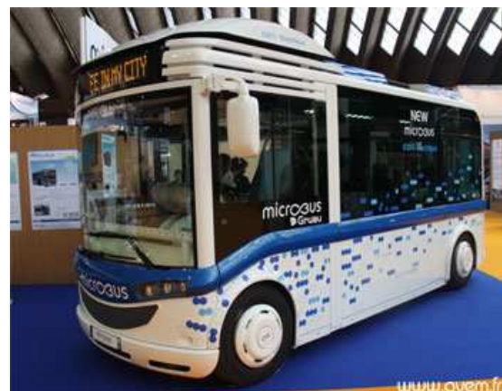
Pour la version électrique du Microbus attendue pour l'été 2010, les batteries sont intégrées sur le toit.
