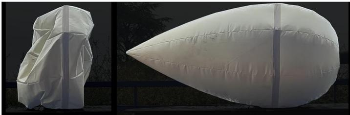
Figure 1: a) Prototypes des carenages avant et arrière à l'arrêt, b) Prototypes des carenages avant et arrière gonflés.
